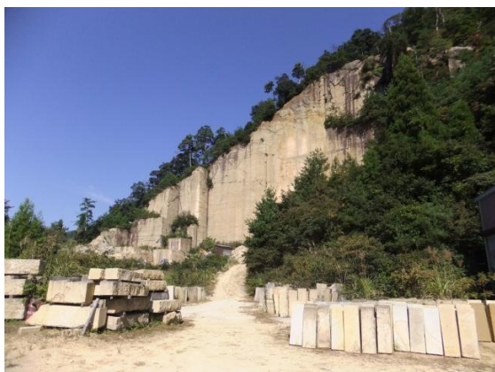
観音下石(日華石)露天掘りの採石場
